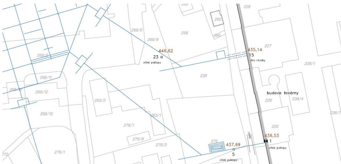
Obr. 5 Výšky vchodů, studny a čerpací šachty
